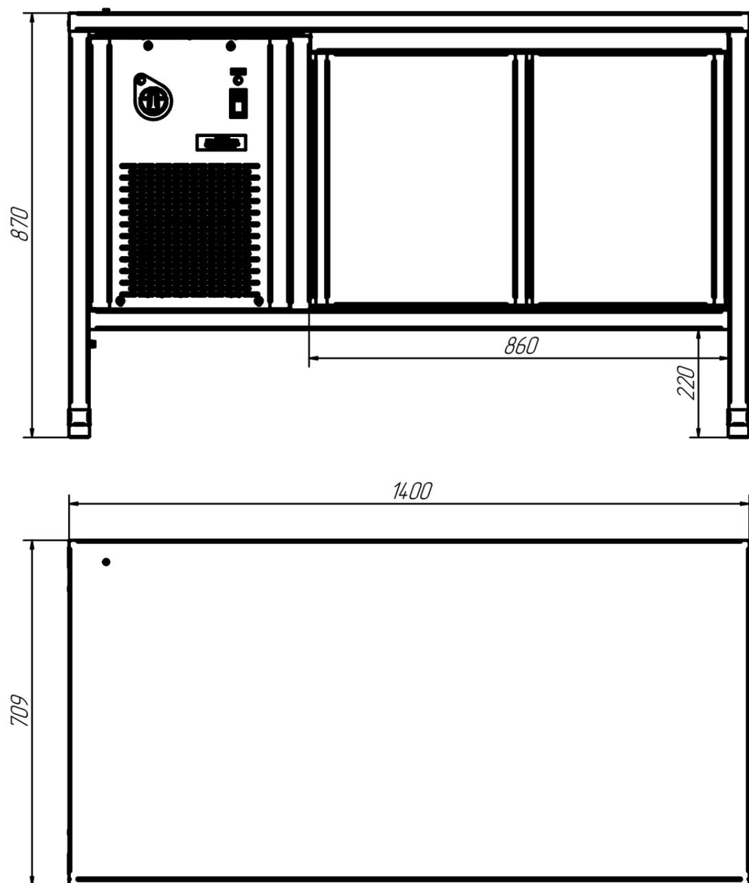
Стол охлаждаемый ПВВ(Н)-70-СО (купе) предназначен для разделки полуфабрикатов мяса и рыбы, может так же использоваться на мясных и рыбных рынках для демонстрации и выкладки продуктов. Рабочая поверхность стола - охлаждаемая ровная поверхность. Внизу расположен шкаф с раздвижными дверками для кухонного инвентаря. Стол имеет регулируемые по высоте ножки.
