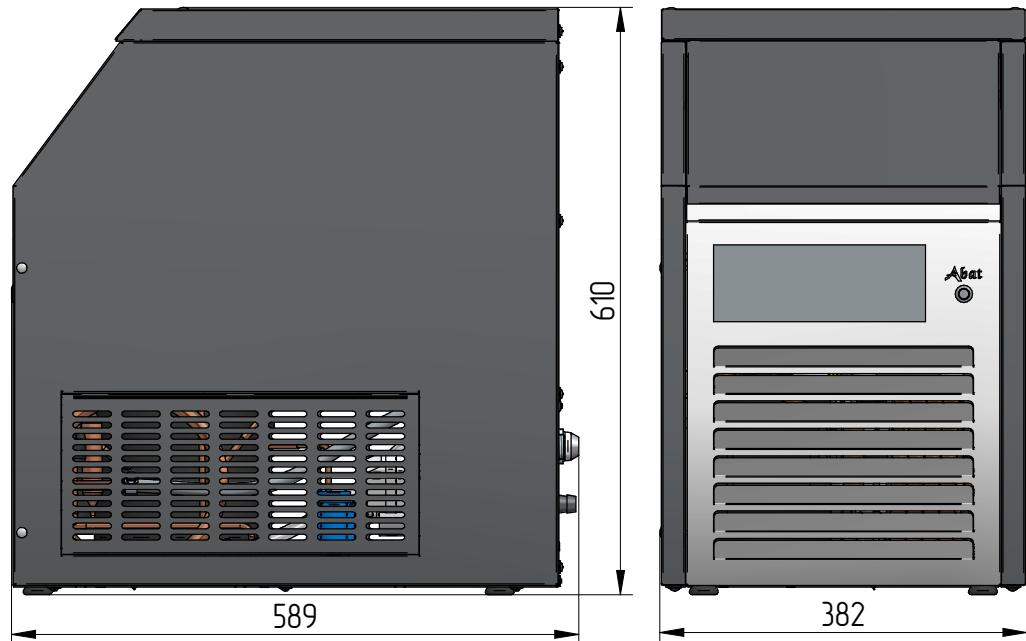
Льдогенераторы кубикового льда ЛГ-24/06К-01, ЛГ-24/06К-02, ЛГ-24/06К-03 и ЛГ-24/06К-04 предназначены для производства кубикового льда высокой плотности, применяемого для длительного охлаждения напитков в кафе, барах, ресторанах.
